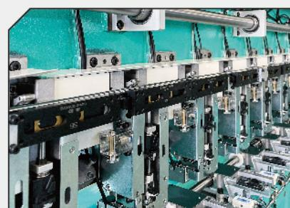
自平衡机头结构、梁前副轴多点传动，双换色，多电机，吊装驱动等结构应用，使设备稳定可靠。
